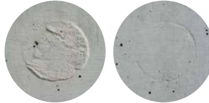
Durch 220 g/m<sup>2</sup> Phenolharz-Beschichtung und wasserundurchlässigem Film auf der Rückseite kaum noch Abdrücke am Beton!
