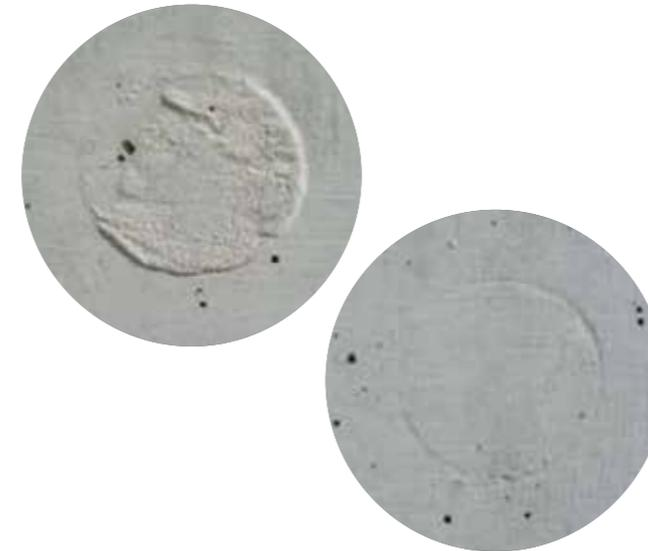
Durch 220 g/m<sup>2</sup> Phenolharz-Beschichtung und wasserundurchlässigem Film auf der Rückseite kaum noch Abdrücke am Beton!
