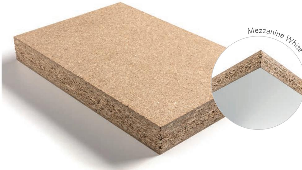
Speziell für Mezzanineböden wurde die extrem starke U7-Grundplatte mit hochdichten und stark verleimten Deckschichten entwickelt. Dadurch sind höhere Belastungen oder größere Zwischenräume der Stützen möglich. Durch die schlankere Gestaltung der Unterkonstruktion, wie z. B. größere Trägerabstände und den Wegfall von Verteilerplatten, können Mezzanineböden kostengünstig verlegt werden.
